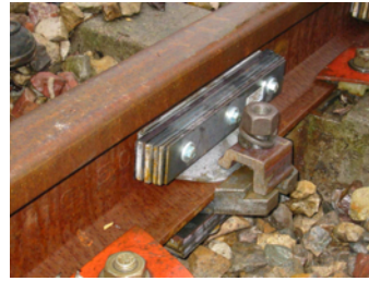
Exemples d'absorbeurs sur rail (Corus et Socitec)
